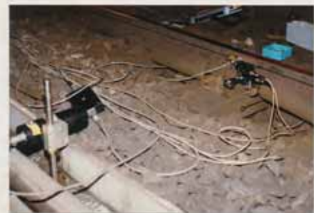
Berührungslose Messung der Auf- und Abbewegungen des Gleiskörpers links
