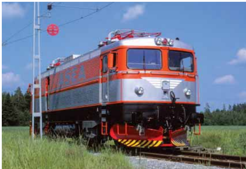
In Sachen Thyristortechnik hatte ASEA bereits in den 1960er Jahren eine Vorreiterrolle eingenommen. Die von der schwedischen Firma gebauten Lokomotiven vom Typ Rc (Baujahre 1967-1988) waren die weltweit ersten in Serie gebauten Thyristorloks und somit technische Vorbilder der Ge 4/4 II.
